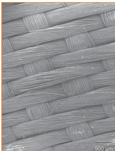
Figure 2 - Micrographie en MEB d'un tissu de carbone ex-cellulose activé à  $900\text{ }^\circ\text{C}$  sous  $\text{CO}_2$ .
