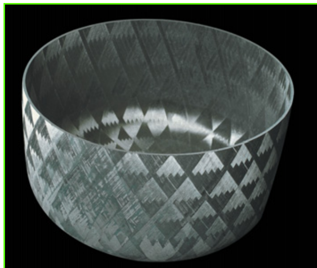
Figure 6 - Creuset pour la fabrication des monocristaux de SiC (diamètre \approx 800 mm).
