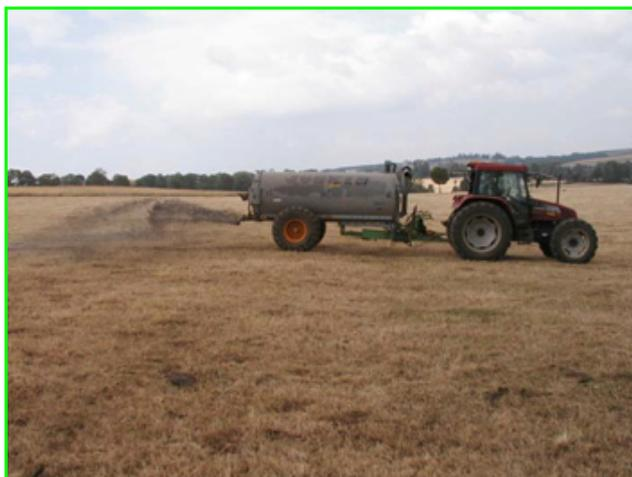
Figure 5 - **Épandage agricole de boues de station d'épuration.** Ces boues issues des stations de traitement des eaux contiennent des fertilisants (azote et phosphore), mais aussi un grand nombre de produits indésirables, notamment des EM. Quel est le devenir de ces EM vis-à-vis des végétaux ou de la faune du sol dans les parcelles épandues ? (Cliché M. Soubrand).
