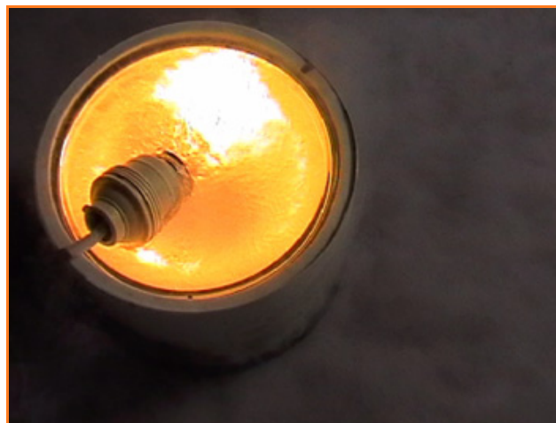
Figure 6 - Filament d'une lampe électrique (bulbe de verre retiré) mis sous tension dans de l'azote liquide.
