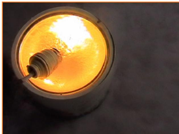
Figure 6 - Filament d'une lampe électrique (bulbe de verre retiré) mis sous tension dans de l'azote liquide.
