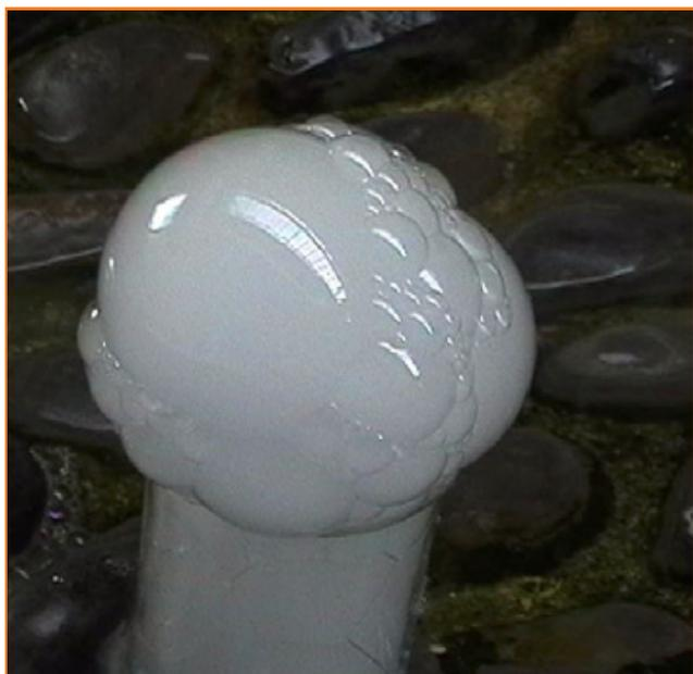
Figure 4 - Production de bulles à partir d'eau savonneuse et d'azote liquide.
