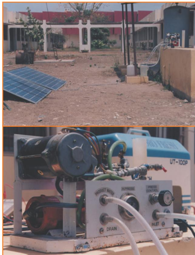
Figure 4 - Première unité mobile d'osmose inverse implantée au Sénégal en 1994, campement villageois de Palmarin, région de Mbour (études préliminaires menées dans le cadre d'un projet sénégal-nippon, Université de Dakar, EPT, 1993).
