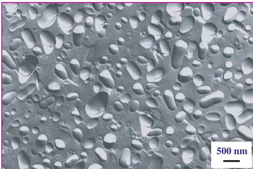
Figure 12 - Vésicules spontanées unilamellaires obtenues avec le tensioactif bicaténaire 4c (cliché de microscopie électronique par cryofracture).
