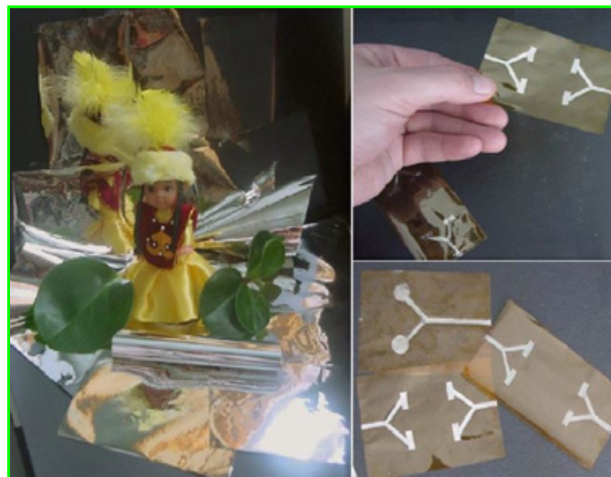
Film Kapton® 100HN de DuPont métallisé argent (à gauche) et motif sur film (à droite).
