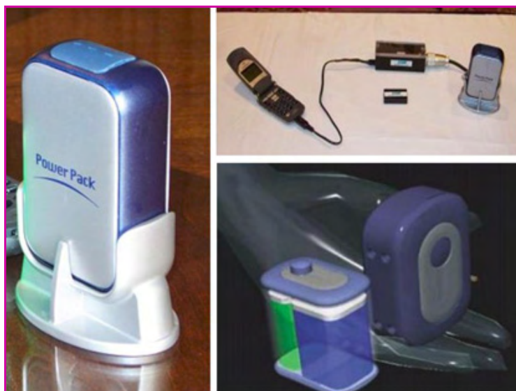
Figure 8 - Prototype d'une pile à combustible à borohydrure direct pour la recharge de téléphone portable (Medis [20]).
