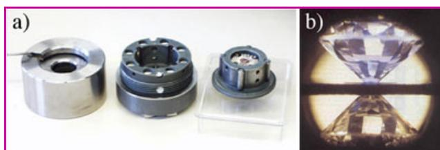
Figure 4 - Illustration d'une cellule à enclumes de diamants (CED).
