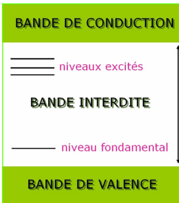
Figure 1 - Schéma de bandes d'énergie simplifié avec les niveaux d'un ion impureté qui se situent dans la bande interdite.
