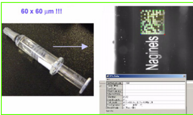
Figure 1 - Lecture d'un code barre bidimensionnel (datamix) de 150\ \mu\text{m} \times 150\ \mu\text{m} gravé à l'intérieur d'une seringue en verre (Lasea).
