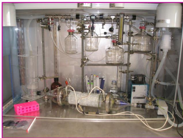
Figure 15 - Montage pour tests photocatalytiques sous UVA (LMSPC-Strasbourg), permettant de désinfecter en mode mono-passage plusieurs dizaines de  $\text{m}^3 \cdot \text{h}^{-1}$  d'air contaminé par exemple par *Escherichia coli* et *Legionella pneumophila*.
