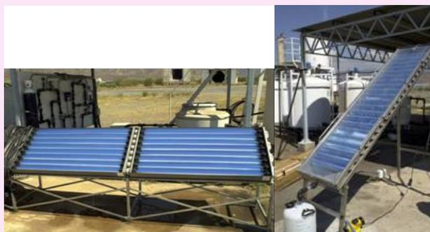
Figure a - Pilote solaire utilisant des suspensions (« compound parabolic collector », CPC) (à gauche) et utilisant le catalyseur supporté Ahlstrom (à droite).
