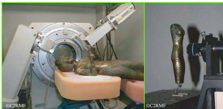
Figure 3 - Dispositifs de diffraction des rayons X et de spectrométrie Raman du C2RMF.
