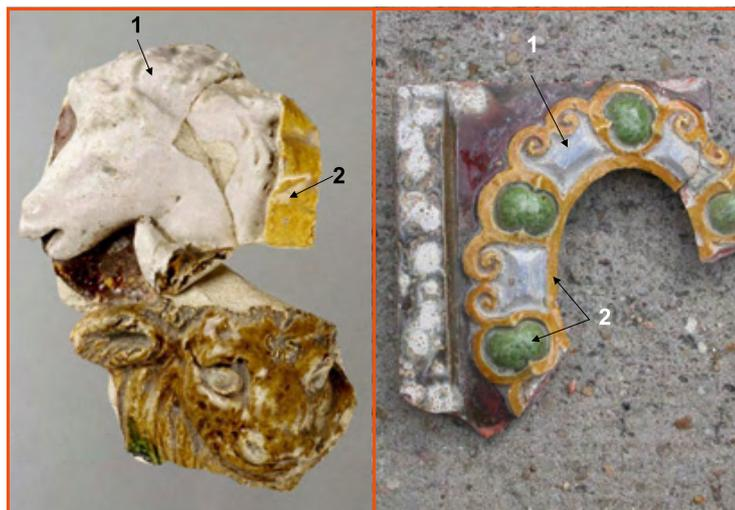
Figure 2 - Fragments de terre cuite glaçurée trouvés dans l'atelier parisien de Palissy et comportant deux types de glaçures (1 = gl. opaque ; 2 = gl. transparente).
