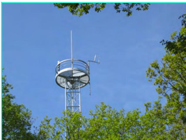
Sommet d'une « tour à flux » destinée à la mesure des flux de carbone (sous forme de gaz carbonique) et d'eau entre un écosystème forestier et l'atmosphère (forêt domaniale de Barbeau, 77). © CNRS Photothèque/PONTAILLER Jean-Yves.
