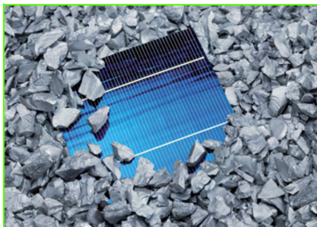
Silicium polycristallin pour cellules photovoltaïque. © Wacker Chemie.
