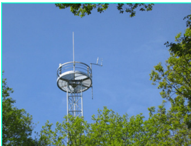
Sommet d'une « tour à flux » destinée à la mesure des flux de carbone (sous forme de gaz carbonique) et d'eau entre un écosystème forestier et l'atmosphère (forêt domaniale de Barbeau, 77). © CNRS Photothèque/PONTAILLER Jean-Yves.
