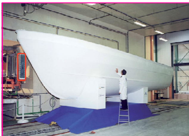
Figure 19 - Coque de bateau de 10 m de long en polyester renforcé de fibres de verre traité par polymérisation induite par faisceau d'électrons et rayons X.
