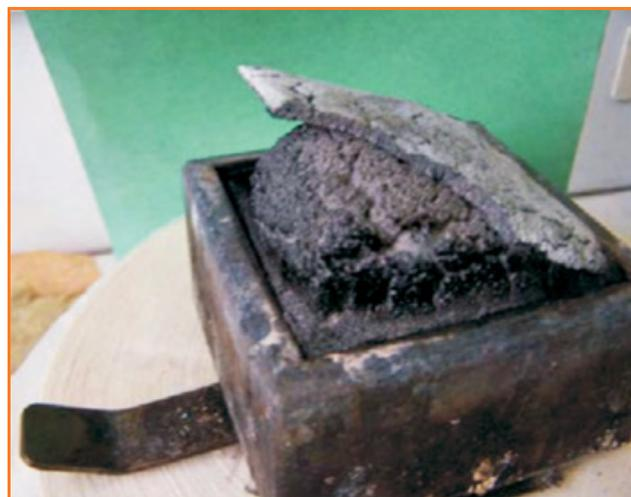
Figure 5 - Illustration du phénomène d'intumescence.
