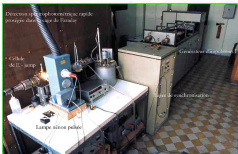
Figure 1 - Installation de relaxation chimique par saut de champ électrique (E-jump).
