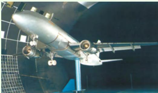
Maquette d'Airbus A 320 dans la soufflerie S1 MA (ONERA).
