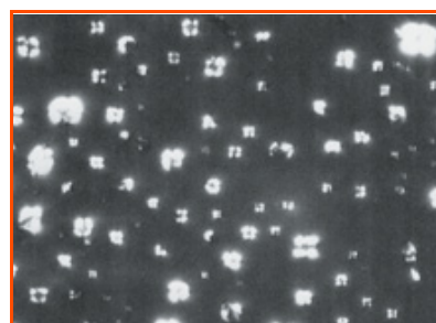
Figure 13 - Visualisation par diffractométrie de cristaux liquides d'APG et d'alcools gras dans une émulsion.
