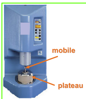
Figure 2 - Rhéomètre à contrainte imposée utilisé pour l'étude et permettant des mesures rotatoires et oscillatoires.
