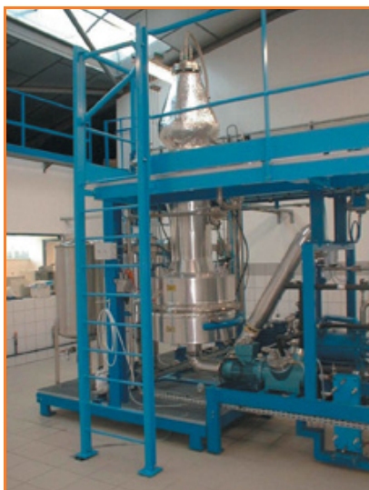
Figure 2 - Unité pilote de biocatalyse solide/gaz (Université de La Rochelle).
