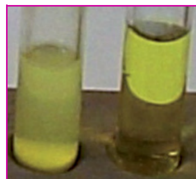
Figure 7 - Essai sur un effluent industriel avant (à droite) et après (à gauche) traitement par le polymère (juste avant l'étape de flottation).
