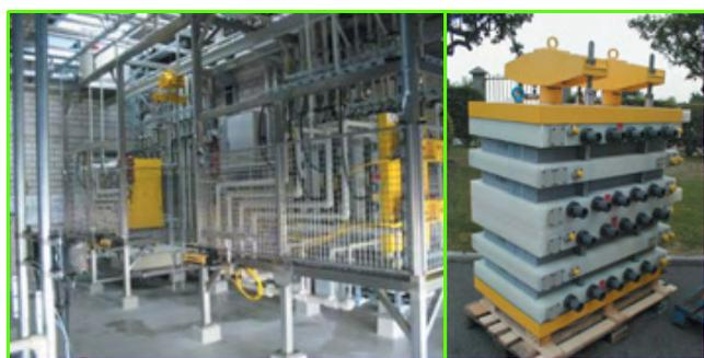
Figure 7 - À gauche : unité bipolaire en industrie pharmaceutique ; à droite : Aqualyzer®EDBM.
