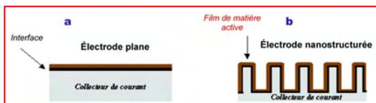
Figure 5 - Vue schématique en coupe d'une électrode plane (a) et d'une électrode nanostructurée (b) avec le collecteur de courant et la matière active.
