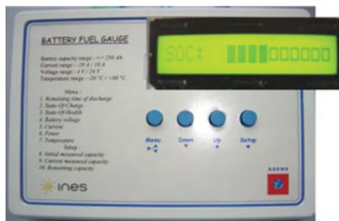
Figure 3 - Tableau de bord d'une batterie au plomb équipé d'une jauge d'état de charge.
