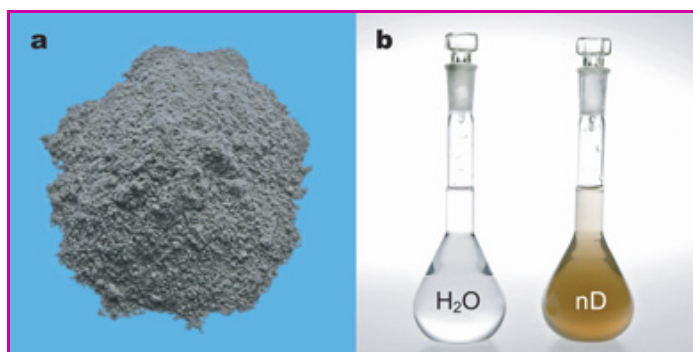
Figure 4 - Aspect macroscopique d'une poudre de nanodiamants élaborés par détonation après purification (a) et d'une dispersion dans l'eau de ces nanodiamants (nD) aux côtés d'une fiole de référence contenant de l'eau pure (b).
