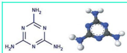
La mélamine : structure semi-développée et structure 3D.
