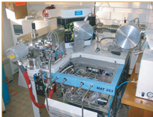
Figure 3 - Spectromètre de masse pour la détermination des rapports isotopiques des sucres et des protéines dans le miel.
