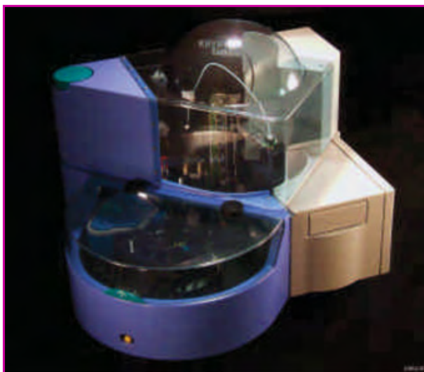
Figure 8 - Lecteur Kryptor® pour les immunodosages TRACE® utilisant un cryptate d'euporium.
