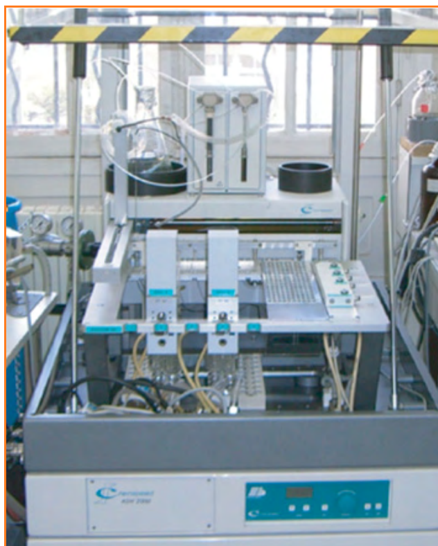
Figure 1 - Automate de synthèse parallèle (ENSCP-CNRS UMR 8151).
