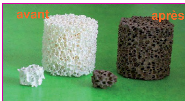
Figure 6 - Aspect des mousses avant et après le dépôt de nanopoudres de Pd-TiO 2 .
