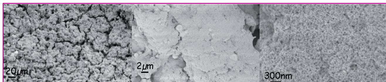
Figure 8 - Microstructure des dépôts de Pd-TiO 2 (TiPdO 3 ) à différents grossissements.
