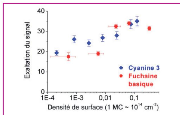
Figure 6 - Facteur d'exaltation de fluorescence d'un film de colorant (cyanine 3 et fuchsine basique) déposé sur un substrat métallisé (Ag 50 nm +  $Al_2O_3$  60 nm) pour différentes densités surfaciques de fluorophores.
