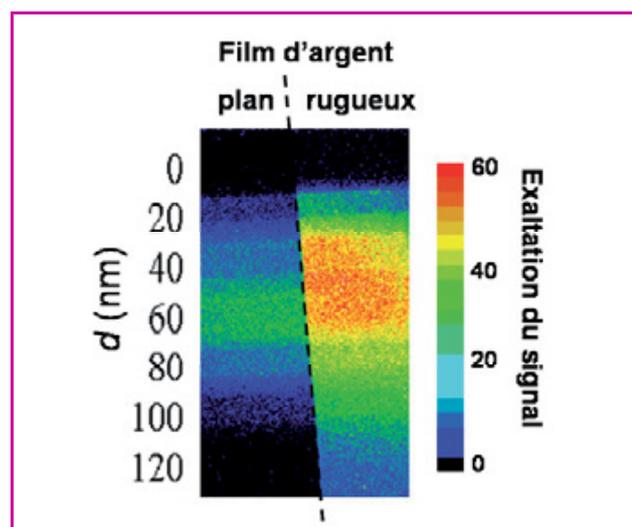
Figure 8 - Image de fluorescence d'un film de colorant (cyanine 3) évaporé sur un film d'argent plan (moitié gauche de l'image) et sur un film d'argent nanorugueux (moitié droite) préalablement recouverts d'une couche d'alumine d'épaisseur variant de 0 à 120 nm par pas de 20 nm.
