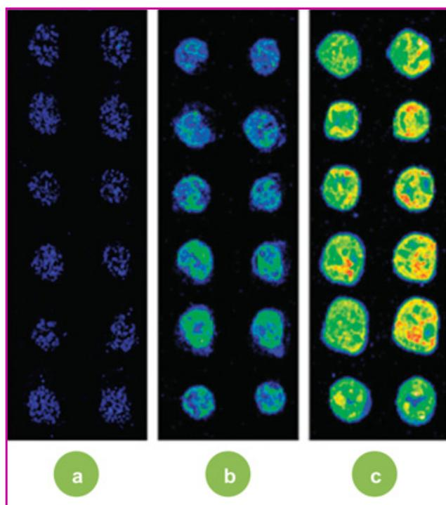
Figure 9 - Images de fluorescence (détails, fausses couleurs) d'une puce à ADN, réalisées dans les mêmes conditions de détection (même puissance d'excitation laser et même sensibilité à la détection), pour trois différents types de substrat : lame de verre standard (a), film d'argent plan (b) et film d'argent nanorugueux (c).
