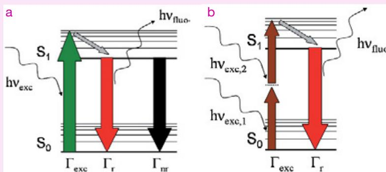
Diagramme simplifié de Perrin-Jablonski pour les processus de fluorescence monophotonique (a) et biphotonique (b).
