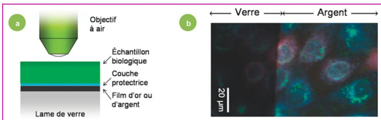
Figure 10 - (a) Schéma d'utilisation des substrats miroirs pour la microscopie d'épifluorescence en biologie. (b) Image de fluorescence (détail) de cellules épithéliales sur un substrat miroir d'argent (le métal est retiré sur la partie gauche de l'image). Marquage fluorescent : microtubules (rouge), appareils de Golgi (vert), mitochondries (bleu).
