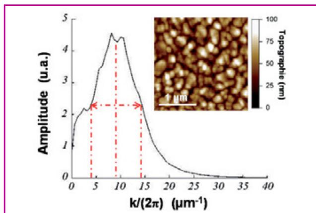
Figure 7 - Distribution de fréquences spatiales de la surface d'un film d'argent nanorugueux.
