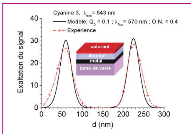
Figure 4 - Facteur d'exaltation théorique et expérimental. Signal de fluorescence calculé pour une assemblée de dipôles orientés aléatoirement, situés à une distance  $d$  de la surface d'argent.
