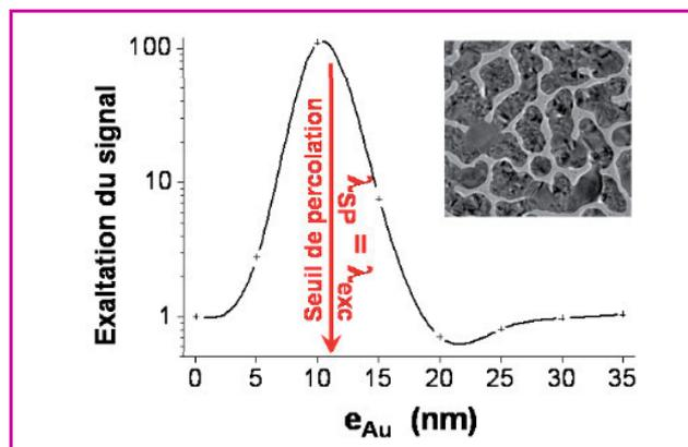
Figure 3 - Facteur d'amplification du signal de fluorescence d'un dépôt d'éosine sur un film d'îlots d'or, sous excitation à deux photons ( $\lambda_{exc} = 833$  nm,  $\lambda_{fluo} = 535$  nm), en fonction de l'épaisseur nominale du film métallique  $e_{Au}$ . Insert : cliché de microscopie électronique en transmission d'un film métallique proche du seuil de percolation.
