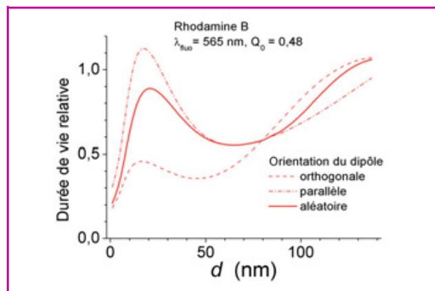
Figure 5 - Durée de vie de fluorescence calculée pour une assemblée de dipôles orientés parallèlement, orthogonalement et aléatoirement, situés à une distance  $d$  de la surface d'argent.
