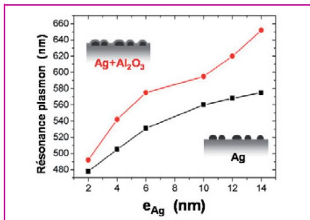
Figure 2 - Position spectrale du maximum d'extinction du film d'argent, déterminée par spectroscopie d'absorption optique en transmission, en fonction de son épaisseur nominale  $e_{Ag}$ . ■ : film nu ; ● : film couvert d'une couche de 2 nm d'alumine.
