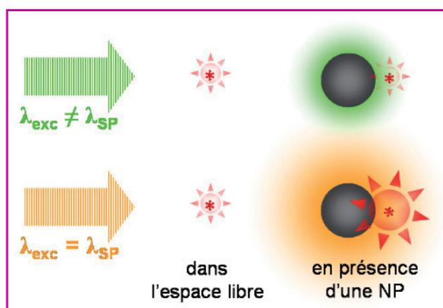
Figure 1 - Schéma d'un fluorophore (\*) dans l'espace libre (1<sup>ère</sup> colonne) et d'un fluorophore couplé à une nanoparticule (NP) métallique (2<sup>e</sup> colonne), excités par un champ électromagnétique à une longueur d'onde lointaine (1<sup>ère</sup> ligne) ou proche (2<sup>e</sup> ligne) de la résonance plasmon (SP) de la nanoparticule. À la résonance plasmon, l'amplification locale du champ électrique autour de la nanoparticule exalte la fluorescence de la molécule.
