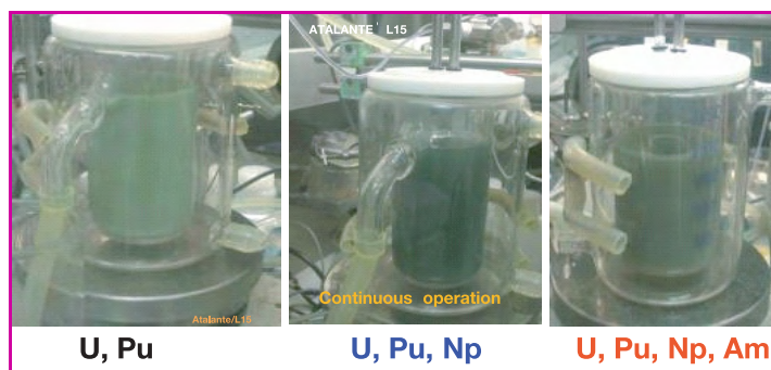
Figure 8 - Précipitation d'oxalates mixtes respectivement de (U,Pu), (U,Pu,Np) et (U,Pu,Np,Am) en réacteur Vortex lors d'essais réalisés au sein de l'installation Atalante du CEA.
