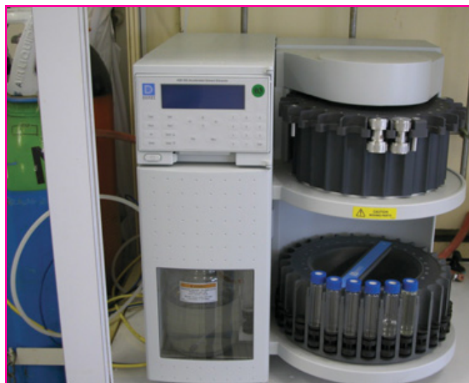
Figure 2 - Le système d'extraction sous haute pression et haute température dénommé ASE (« accelerated solvent extraction »).
