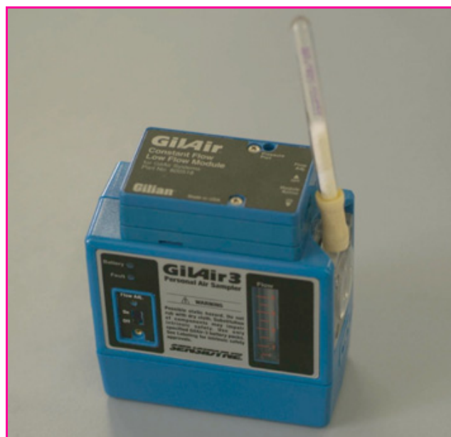
Figure 5 - Fibre SPE montée sur sa pompe de prélèvement (prélèvement à poste fixe).
