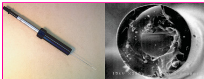
Figure 2 - Fibre SPME vue en coupe au microscope électronique à balayage (à droite), vue complète (à gauche).
