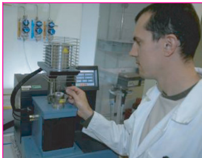
Calorimètre différentiel à balayage utilisé pour la caractérisation thermique des explosifs. Il permet entre autres de déterminer la température de décomposition de l'explosif à partir de quelques milligrammes de matière.
