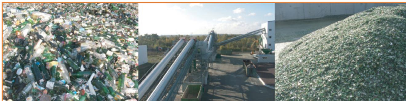
Figure 5 - Le recyclage du verre, de gauche à droite : verre avant traitement, centre de traitement et verre après traitement.
