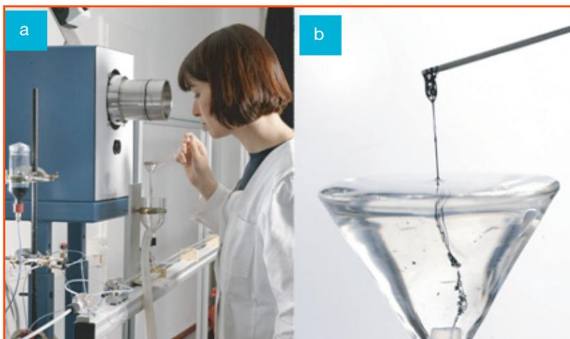
Figure 5 - a) Photographie de la première ligne de filage continue « monofilament » de fibres nanocomposites de nanotubes ; b) Zoom sur la zone d'extraction de la fibre.
