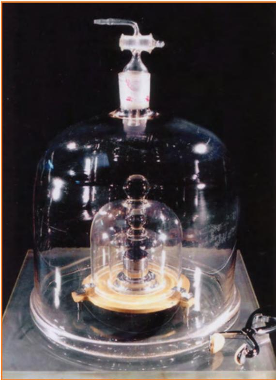
Figure 2 - Le kilogramme étalon en platine iridié déposé au Pavillon de Breteuil qui sert d'étalon depuis 1904.
