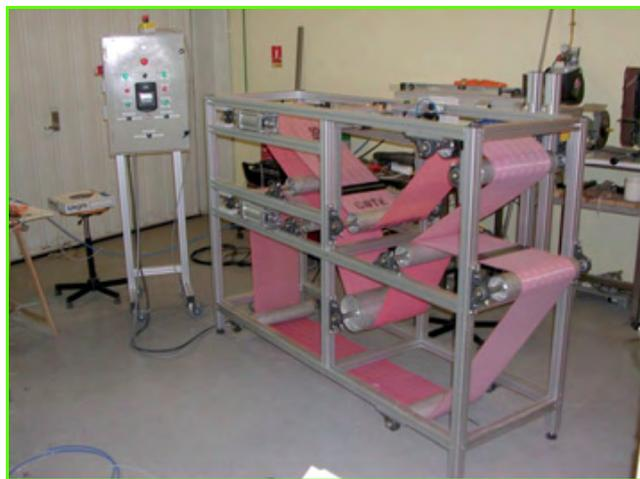
Figure 8 - Unité pilote de filtre à bandes pour la déshydratation des boues de station d'épuration.
