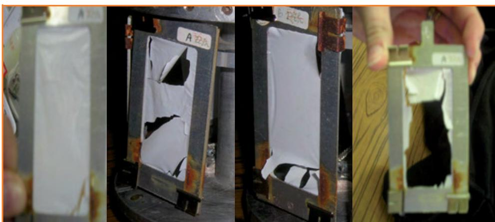
Figure 28 - Étude de la dégradation d'un film biosourcé.
