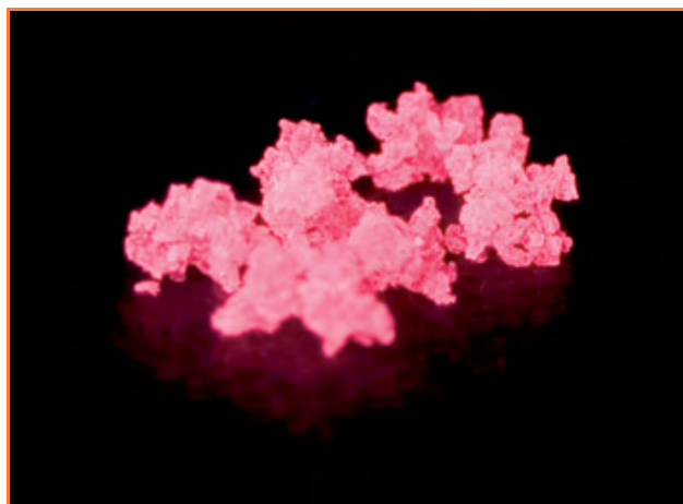
Figure 5 - Agrégat de nanoparticules de silice dans lesquelles un composé à base de ruthénium, luminescent, a été intégré.
