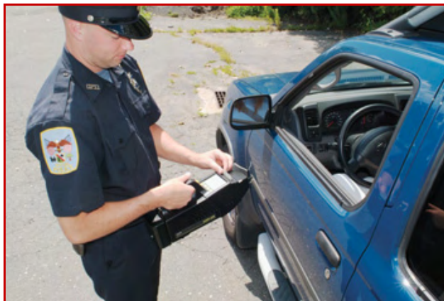
Le détecteur portable SABRE 4000 peut identifier plus de 40 explosifs, armes chimiques, produits toxiques et stupéfiants en moins de dix secondes. © Smith Detection.
