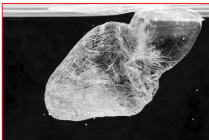
Figure 4 - Cellule osmotique produite par l'introduction d'un bloc de chlorure de calcium fondu dans une solution très diluée. Les aiguilles sont des cristallisations microscopiques, invisibles à l'œil nu.
