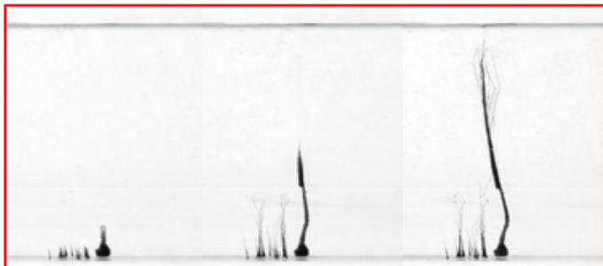
Figure 8 - Deux solutions de silicate de sodium, l'une concentrée, l'autre diluée deux fois, ont été disposées l'une au-dessus de l'autre. L'arborescence de chlorure de cobalt change de structure lorsqu'elle la traverse.
