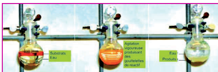
Figure 2 - Le protocole expérimental d'une réaction organique dans l'eau « on-water » [6].
