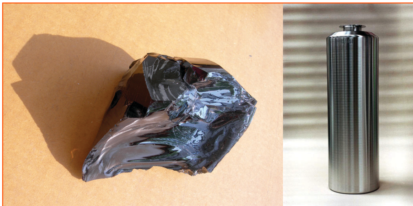
Figure 4 - Échantillon du matériau verre représentatif de la matrice de déchet de haute activité et à vie longue et colis agrégé pour contenir ces déchets. © Andra.
