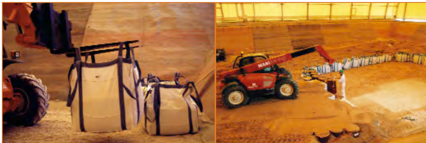
Figure 1 - Conditionnement « big bag » pour des déchets de très faible activité et alvéole de stockage de déchets de très faible activité en exploitation. © Andra/R. Leenhardt (à gauche) et © Andra/E. Gaffard (à droite).
