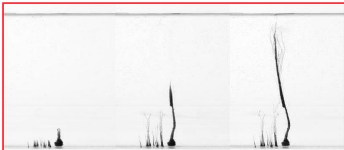
Figure 8 - Deux solutions de silicate de sodium, l'une concentrée, l'autre diluée deux fois, ont été disposées l'une au-dessus de l'autre. L'arborescence de chlorure de cobalt change de structure lorsqu'elle la traverse.
