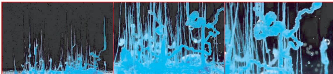
Figure 7 - Différentes étapes de la croissance filiforme de fins cristaux de sulfate de cuivre, illustrant particulièrement bien l'influence des bulles de gaz. Plan large et gros plan.
