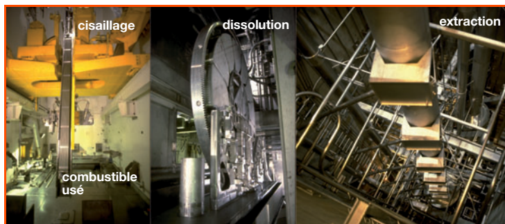
Figure 9 - Les étapes du traitement des assemblages combustibles usés. De gauche à droite : cellule d'alimentation et dissolvant roue de l'atelier de cisaillage et dissolution, colonnes pulsées de l'atelier hautes activités extraction, usine de traitement des combustibles usés UP3, AREVA, La Hague, Cherbourg. © AREVA/JEZEQUEL Sidney.
