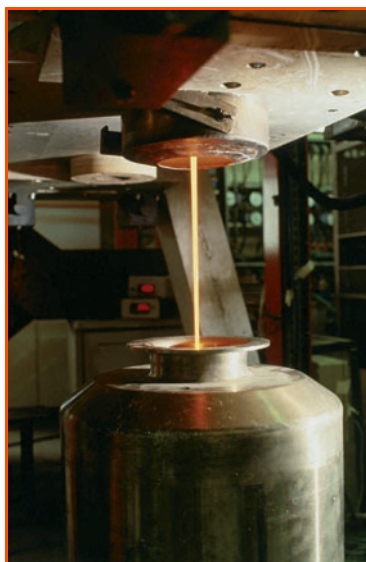
Figure 11 - Coulée de verre. Centre d'études de la vallée du Rhône, atelier de vitrification de Marcoule. © CEA.
