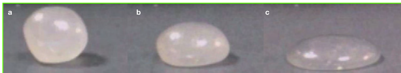
Figure 1 - Un liquide viscoélastique tel que cet échantillon de poly(diméthylsiloxane) (silicone) de grande masse moléculaire se comporte comme un solide aux temps courts et comme un liquide aux temps longs. Les clichés a), b) et c) sont respectivement pris 5 s, 100 s et 1 000 s après avoir déposé la boule de polymère.
