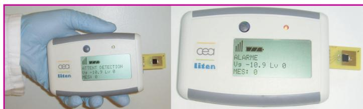
Figure 8 - Prototype de détection de composés organophosphorés neurotoxiques développé par les auteurs.
