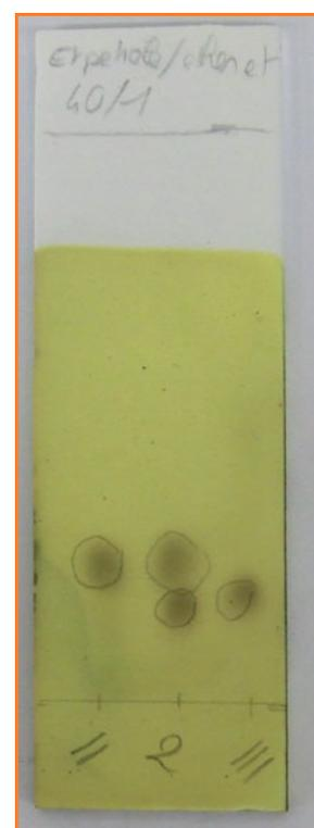
Figure 6 - La plaque CCM révélée par l'acide phosphomolybdique (éluant : éther de pétrole/éther diéthylique 40/1 V/V). Dépôts : produit (à gauche) ; alcène (à droite) et co-dépôt (au centre).
