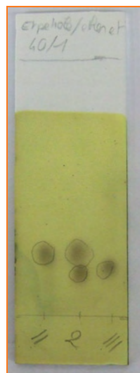
Figure 6 - La plaque CCM révélée par l'acide phosphomolybdique (éluant : éther de pétrole/éther diéthylique 40/1 V/V). Dépôts : produit (à gauche) ; alcène (à droite) et co-dépôt (au centre).
