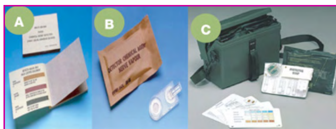
Figure 4 - Techniques de détection chromogéniques : A) papier PDF1 ; B) détecteur NAVD ; C) M256A1 Chemical Agent Detector Kit, US Army.
