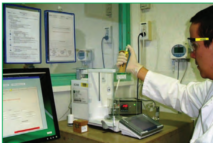
Vérification métrologique des micropipettes. © SCA/CNRS.
